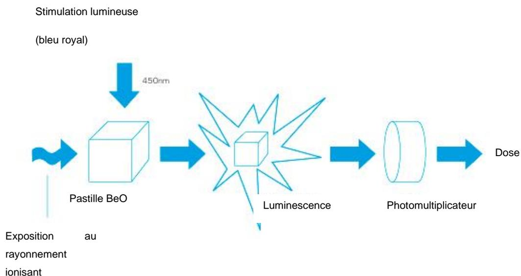
En raison de l'équivalence tissu du BeO, la courbe de réponse en énergie est pratiquement plate. Cela signifie qu'il ne faut pas de filtres de correction.
