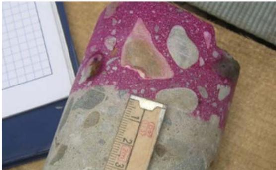
Une **deuxième option** consiste à retirer des carottes de béton de la structure et à les pulvériser de phénolphthaléine. La partie décolorée indique le béton non carbonaté. Cette méthode est donc plus précise, mais provoque également plus de dommages à la structure, ce qui signifie que moins de mesures sont possibles qu'avec la collecte de poussières de forage.
