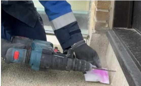
**Deux méthodes** sont utilisées pour effectuer ces mesures. La **méthode la plus simple, mais aussi légèrement moins précise**, consiste à percer des trous dans l'élément en béton. Lors du perçage, la poussière de perçage est collectée sur un chiffon imbibé de phénolphthaléine. Lorsqu'une coloration se produit, le béton non carbonaté est atteint. La profondeur du forage correspond alors approximativement à la profondeur du front de carbonatation.
