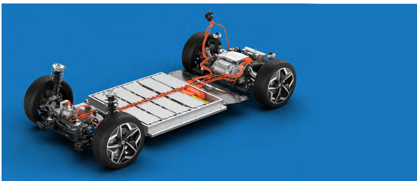
Fig. 8 : emplacement typique d'un pack de batterie dans un véhicule électrique Source: https://www.anwb.nl/auto/elektrisch-rijden/elektrische-autos/accus-techniek-en-kosten
